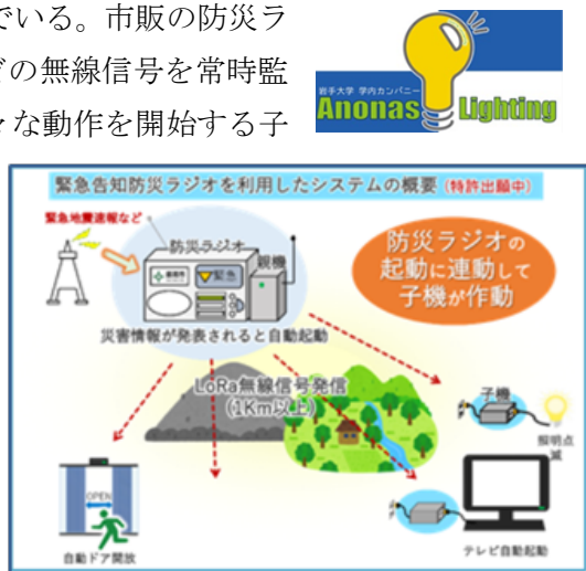
図 12 緊急告知防災ラジオを利用したシステム
